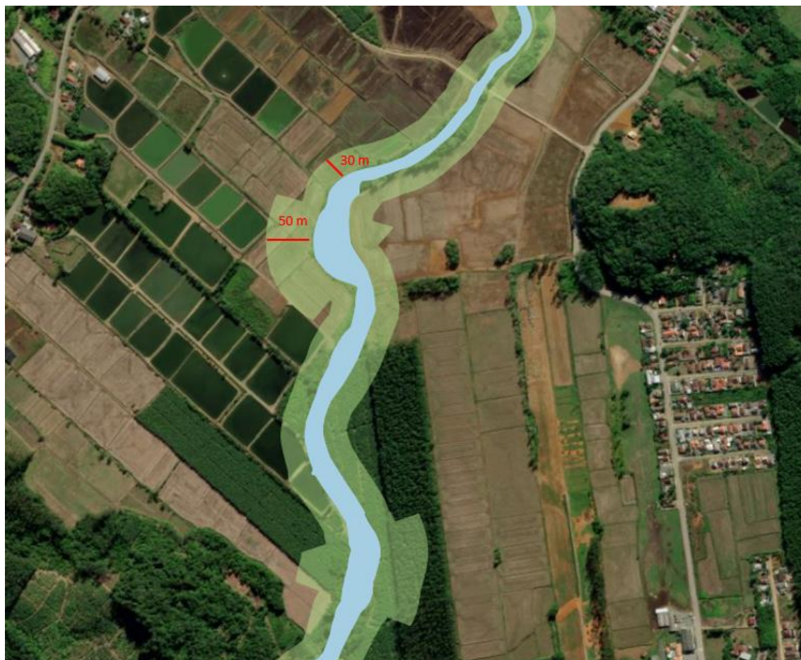
Figura 134. Faixas de APP ao longo de cursos d'água determinadas conforme as larguras de secção da calha regular.
