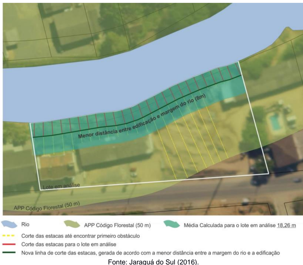
Figura 137. Exemplo de lote urbano com representação da APP segundo o Código Florestal; da menor distância entre a edificação e a margem do rio; da linha média calculada para o lote.
