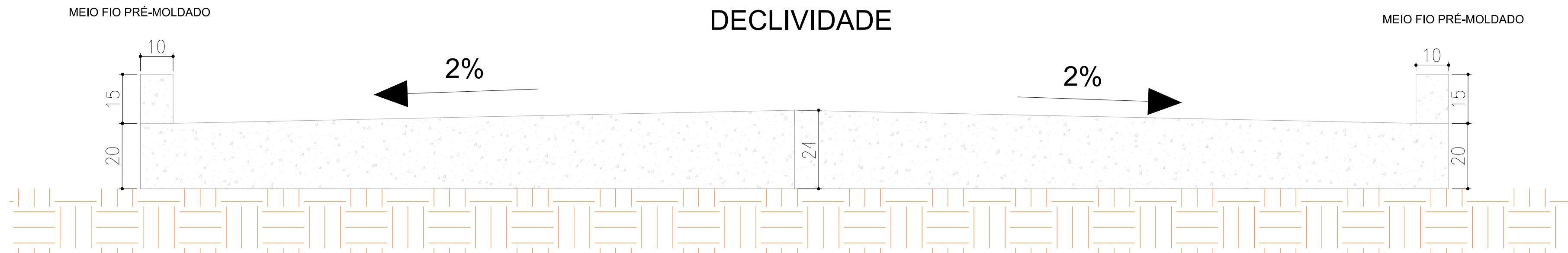
PERFIL DO PAVIMENTO ESC. 1/10
